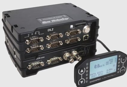
*Le DASH4Pro peut être raccordé en RS232 et CAN aux modules de mesure ANALOG16 et THERMO12 afin d'afficher les mesures en cours.*
