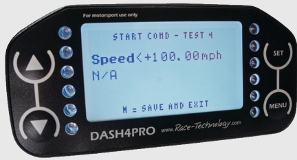
Condition de déclenchement
