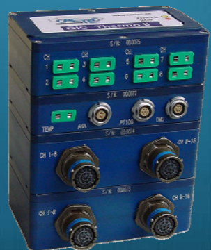
Modules d'Acquisition avec conditionnement et alimentation des capteurs (étanches -40°C @ 85°C)
